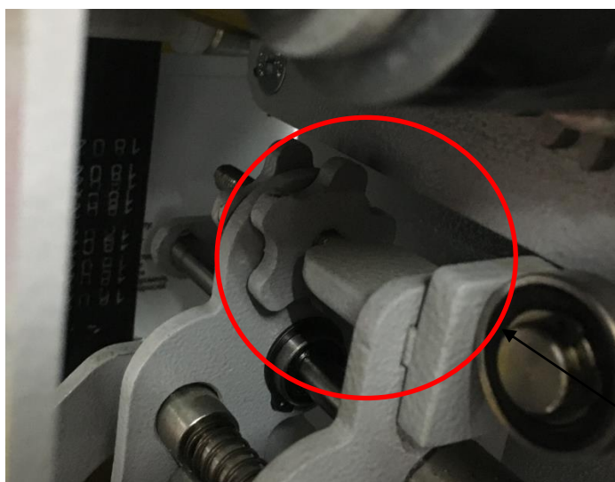
Rys. 9.17 – Nakrętki regulacyjne długości przeciągania taśmy
