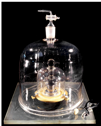
Rys. 1.3. Międzynarodowy wzorec masy 1 kg w postaci wykonanego z platyny i irydu walca o wysokości i średnicy podstawy równej 3,9 cm (dzięki uprzejmości Bureau International des Poids et Mesures, przedruk za zgodą BIPM)
