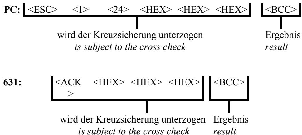
$$\text{BCC} = \text{<} \text{ACK} \text{>} \text{ XOR } \text{<} \text{HEX} \text{>}$$
