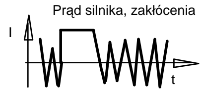
Prąd silnika, zakłócenia Zbyt duże P, lub stała czasowa I za mała
