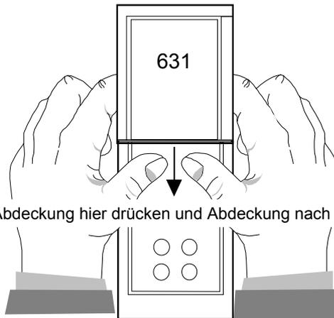
Zum Entfernen der Abdeckung hier drücken und Abdeckung nach unten wegziehen
