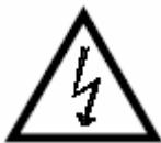
**Warnung – Gefährliche elektrische Spannung:** Bauteile im inneren des Gerätes führen hohe Spannungen. Beachten Sie daher die Warnhinweise, bevor Sie Arbeiten am offenen Gehäuse durchführen.
