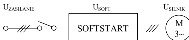
Schemat blokowy połączenia softstartu.
