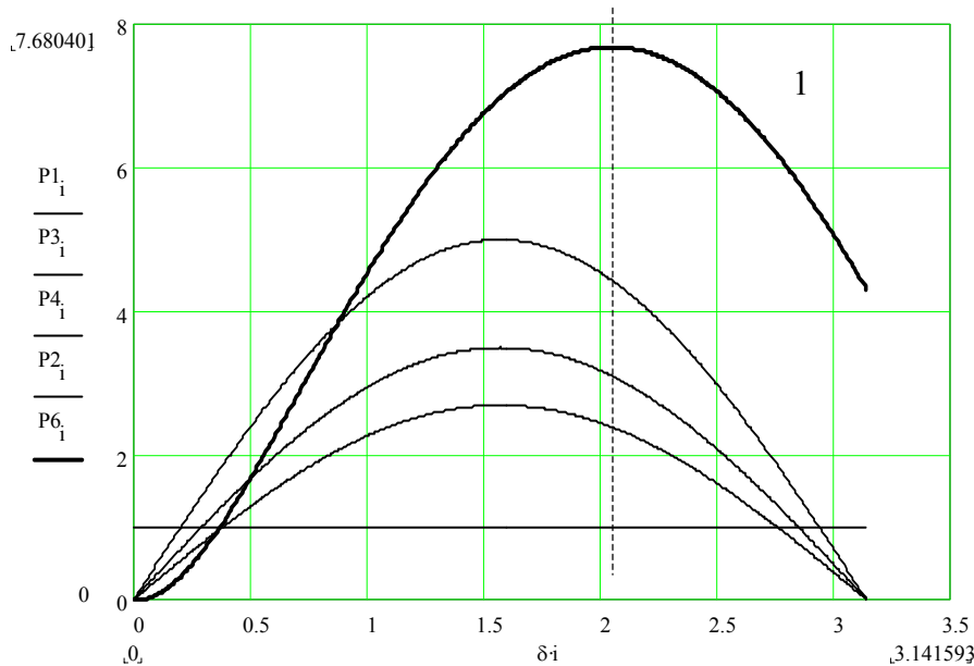
Rys. 4.7 Moc elektryczna i mechaniczna generatora w funkcji kąta \delta w przypadku, gdy generator jest wyposażony w szybkie regulatory wzbudzenia
