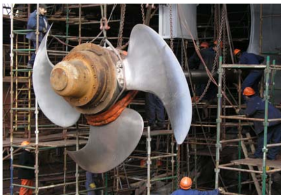
Rys. 5. Demontaż śruby typu High Skew na statku m/s „Lysvik” na doku stoczni (zdjęcie własne) Fig. 5. Dismantling of High Skew Propeller in the Nauta dry dock
