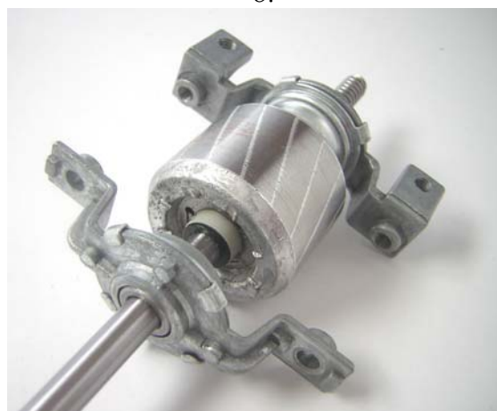
Rys.13.17. Budowa silnika indukcyjnego zwartobiegunowego a. rozpływ składowych strumienia magnetycznego, b. kompletny silnik, c. wirnik klatkowy.
